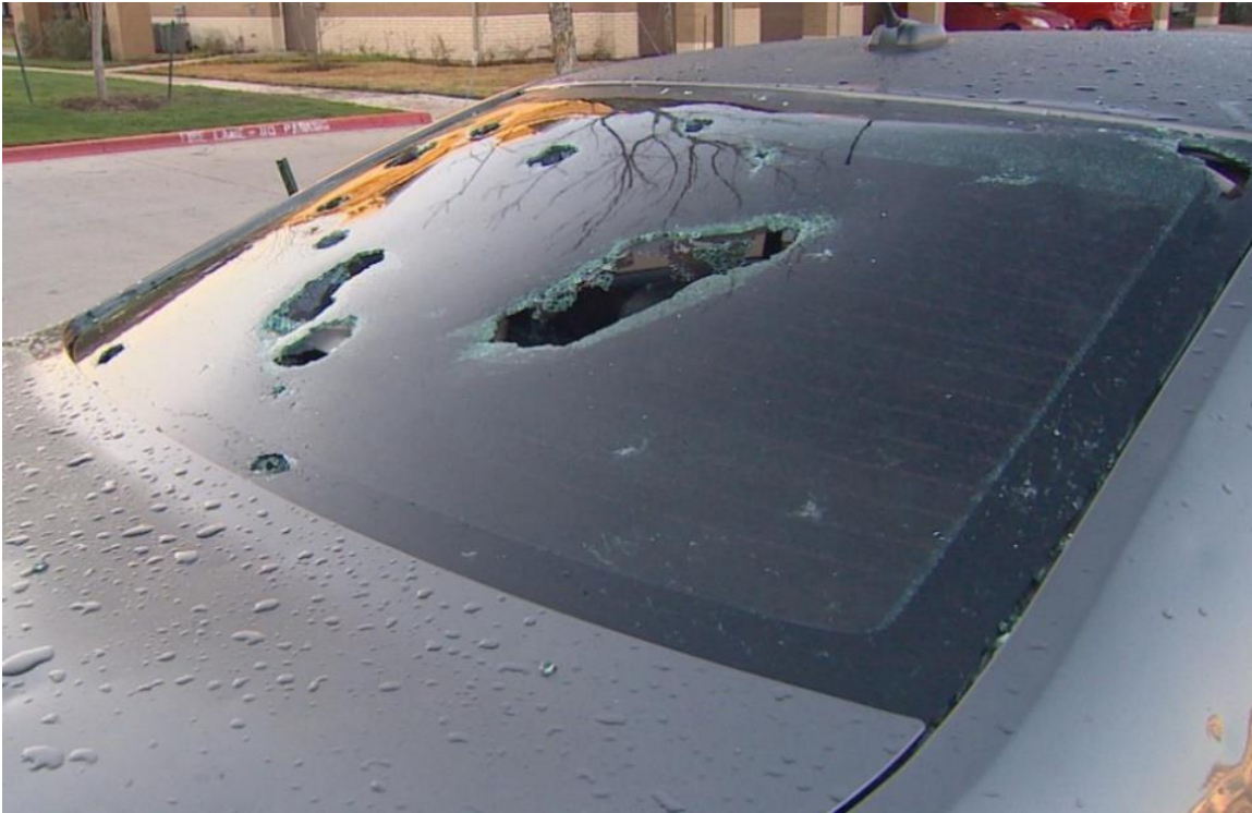
Hình 2-43: Thiệt hại do mưa đá sau trận bão tháng 3/2019 ở khu DFW. 207
