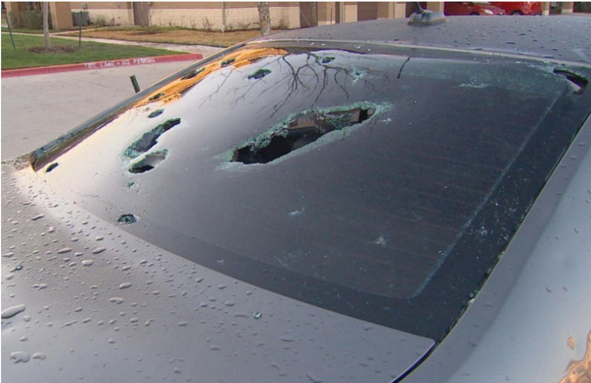
图 3-35: 2019 年 3 月达拉斯沃斯堡地区发生风暴后冰雹造成的损坏。 210
