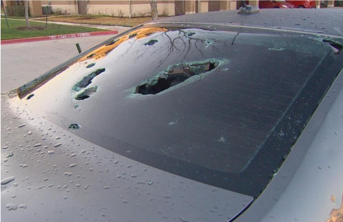
Figura 3-45: Daño por granizo después de una tormenta en marzo de 2019 en el área de DFW. 210
